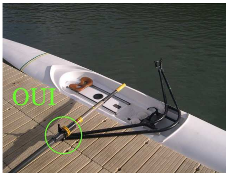
pelle bâbord (rouge) installée en premier
